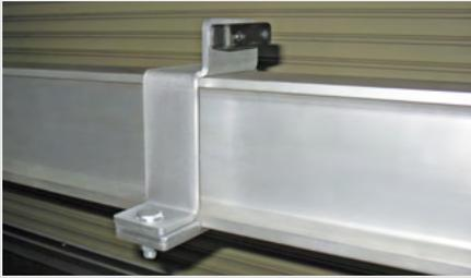
任意の位置で固定することができ、門型完成後の取り付け、取り外しが可能です。トロリストッパーを使い、トロリ可動域を制限することもできます。トロリの破損を防ぐ緩衝材付きです。
