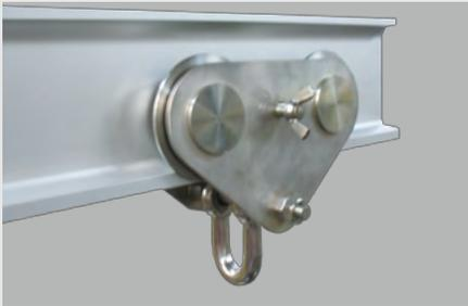
オールステンレス製のプレントロリです。両側板の蝶ネジにより任意の位置で簡易固定ができます。I形鋼やH形鋼専用での製作も可能です。
